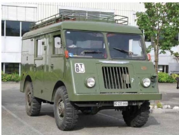
◀▲ Radio-uitvoering met de geheel gesloten opbouw. Achterin waren opbergkasten voor een generator en het reservewiel. Er was ruimte voor de radio en acht personen.
