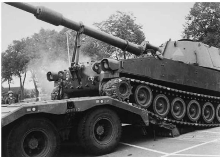
1980: Een M109A1 gemechaniseerde 155mm houwitser wordt op een DAF YTS 10050 50-tons tankoplegger geladen. De chauffeur moet geheel vertrouwen op de aanwijzingen van zijn collega op de voorgrond. (NIHM: ▲2044_062442 en ▼2044_062443)
