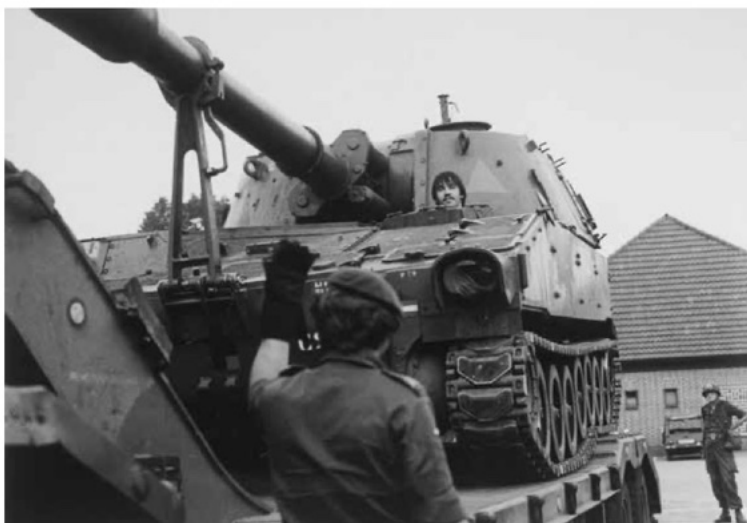
1980: Een M109A1 gemechaniseerde 155mm houwitser wordt op een DAF YTS 10050 50-tons tankoplegger geladen. De chauffeur moet geheel vertrouwen op de aanwijzingen van zijn collega op de voorgrond. (NIHM: ▲2044_062442 en ▼2044_062443)
