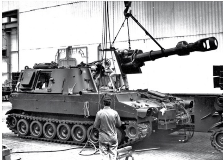
Twee foto's van de montage van de 155mm houwtiser bij WF&RDM Algemene Werktuigbouw te Schiedam. (fotocoll. Wim den Dunnen)
